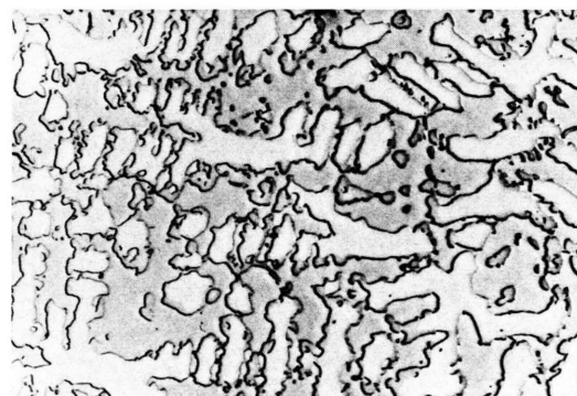
Abb. 10. V_{63}Si_{14}Al_{23} nach 300 h bei 1000 °C. Auf gleicher Höhe im geätzten Schliff liegen die helle A15-Phase und dunkles V_5Si_3 . Die dunkle A2-Phase hebt sich von ihnen durch eine Stufe ab. Vergr. 350-mal.
