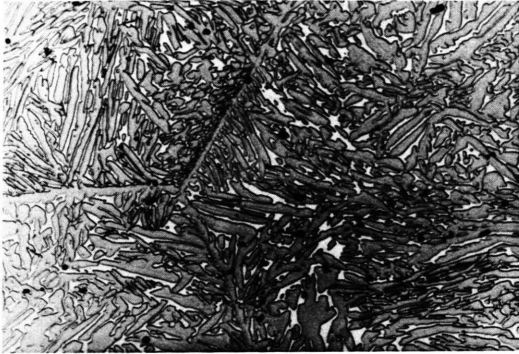
Abb. 4. V_{74.1}Ga_{15.2}Al_{10.7} ; A2—A15 Phasengemenge, entstanden nach 24 h bei 1000 °C aus A2-Phase (hell); Vergr. 140-mal.
