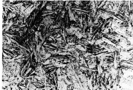
Abb. 5. V_{74.1}Ga_{15.2}Al_{10.7} ; A15-Phase, entstanden aus A2-Phase nach 20 h bei 800 °C; Vergr. 350-mal.
